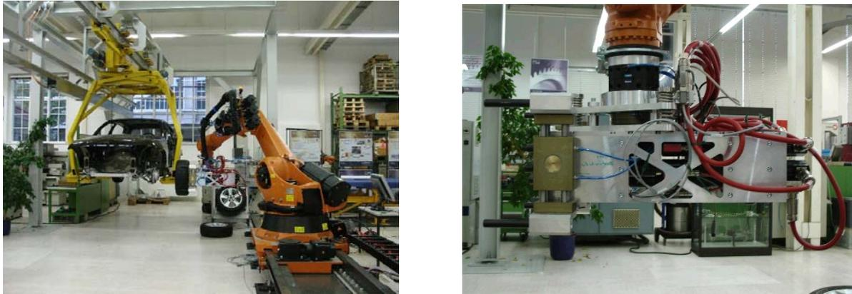
Bild 1: links: Gesamtansicht mit einem auf einer Linearachse montierten KUKA-Roboter und einer durch eine Elektrohängebahn transportierte Karosse;
