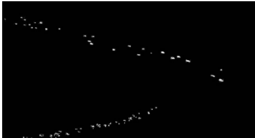
Abbildung 7: Differenz eines Bildes zum Median Bild, oben: Fahrzeuge auf dem Mittleren Ring, unten Fußgänger
