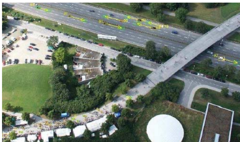
Abbildung 8: Automatisch bestimmte korrelierte Fahrzeuge und Geschwindigkeiten als Vektoren
