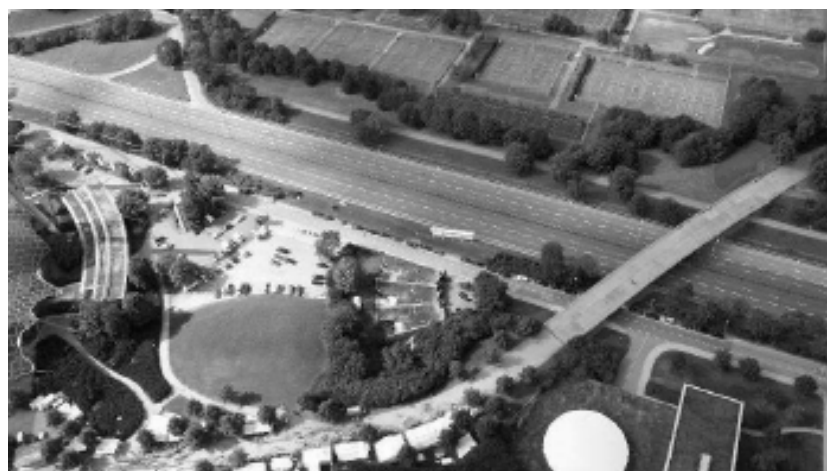
Abbildung 6: Median Bild errechnet aus der Bildserie – keine Fahrzeuge auf dem Mittleren Ring
