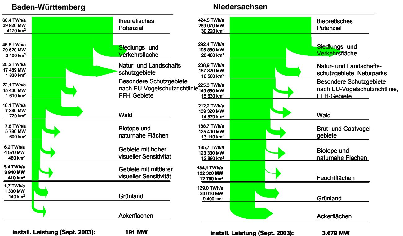
Abbildung 4.4: Potenzial zur Nutzung der Windenergie in Baden-Württemberg und Niedersachsen unter Berücksichtigung verschiedener Restriktionen des Natur- und Landschaftsschutzes (Ergebnisse für 1,5 MW Referenzanlage)
