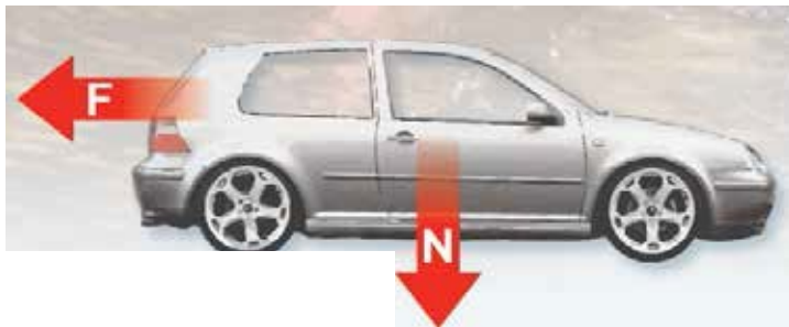
Figur 2 Friksjons- og normalkrefter på en bil (hs) (SVV rapport nr. 310, juli 2014)
