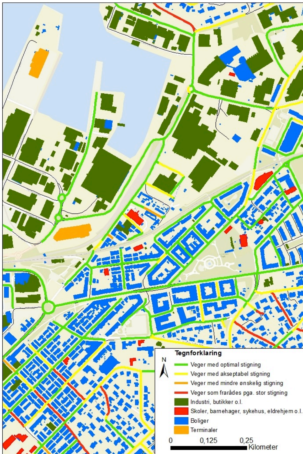
Figur 37: Ulike stigningsgrader og bygninger på Lademoen
