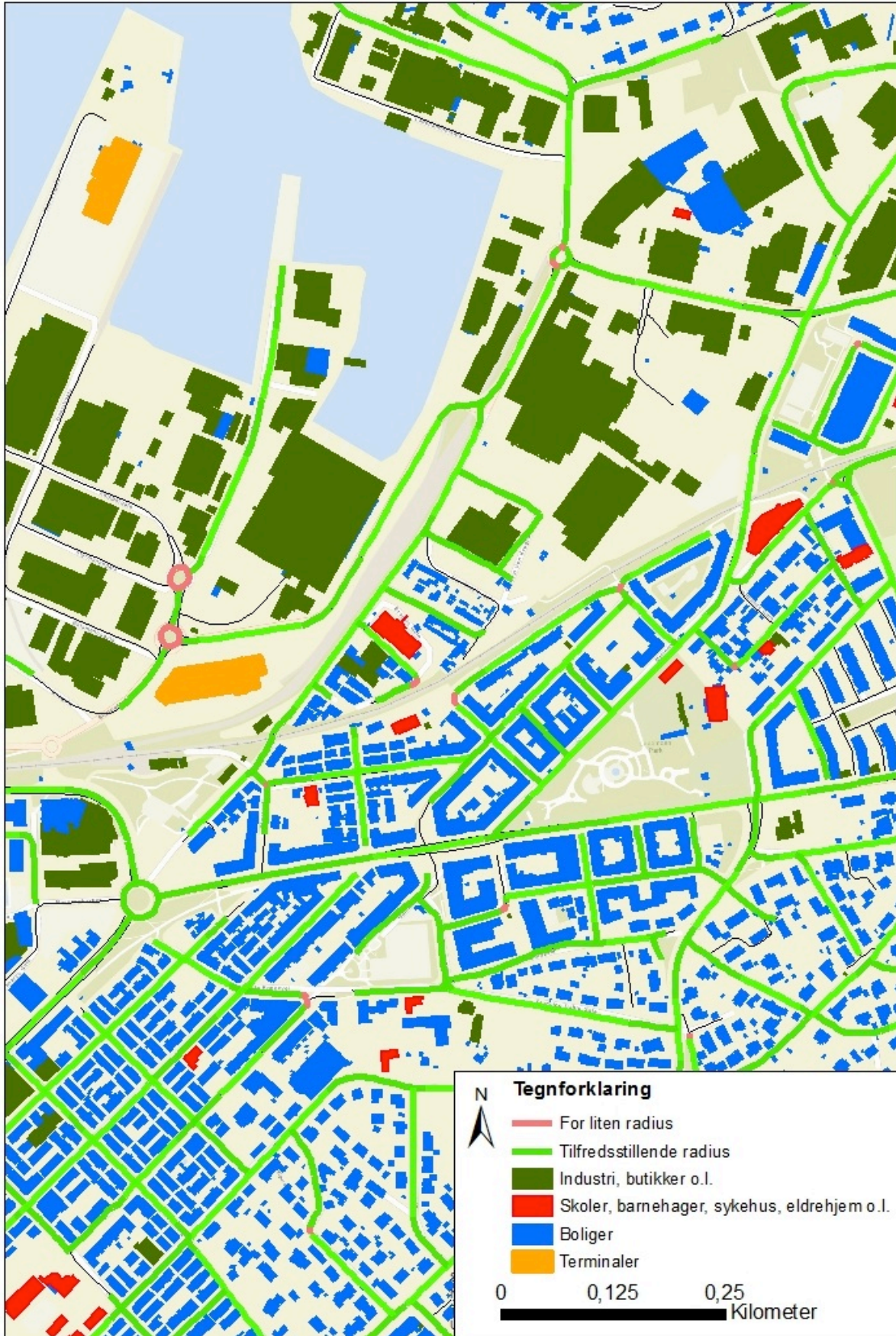
Figur 45: Oversikt over radier til kurver på Lademoen
