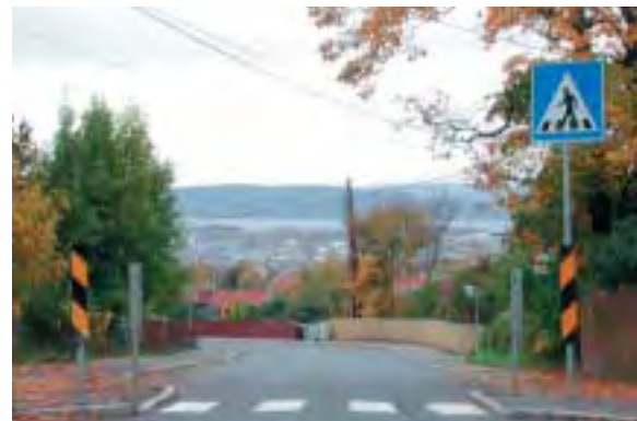
Innsnevring av kjørebane reduserer i noen grad hastigheten.
