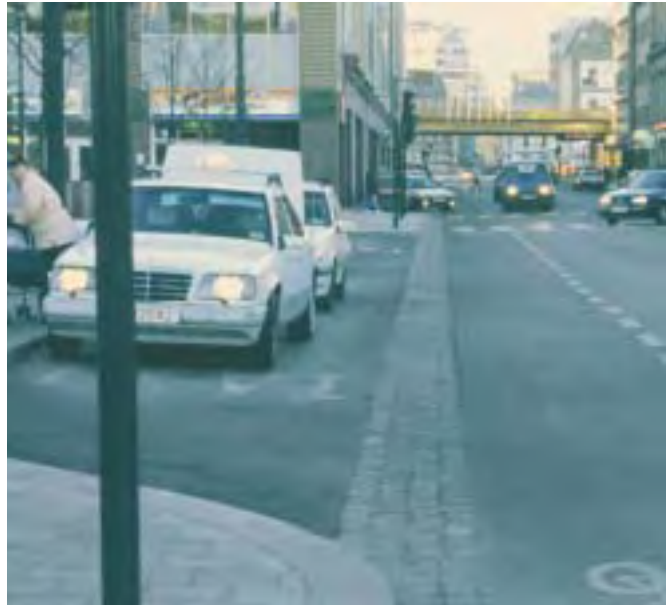
Drosjeholdeplass innenfor sykkelfelt. Merk buffersone som sikrer avstand mellom biler og syklister. Grønland, Oslo.
