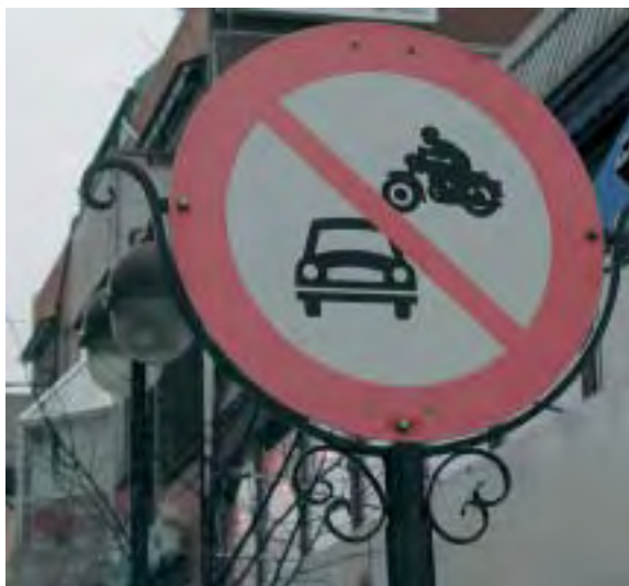
Skilt 306.1 Forbudt for motorvogn kan brukes for å legge til rette for envegs trafikk for andre kjøretøy enn sykkel.
