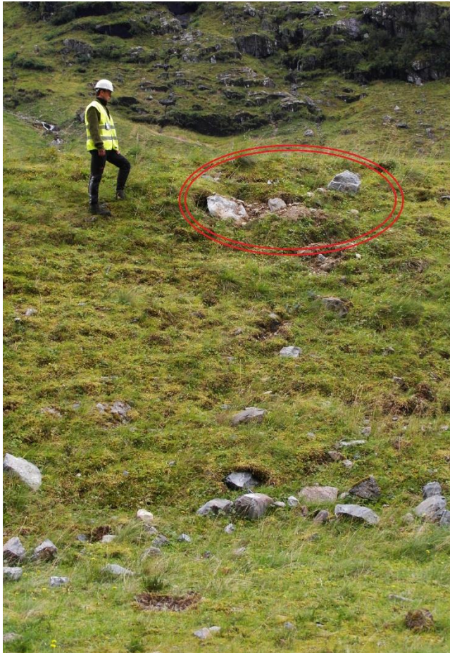
Figur 41: Blokker har sprettet og trengt inn høyt oppe i støtsiden til Våtedalsvollen 1 (foto: Feltarbeid 2013).
