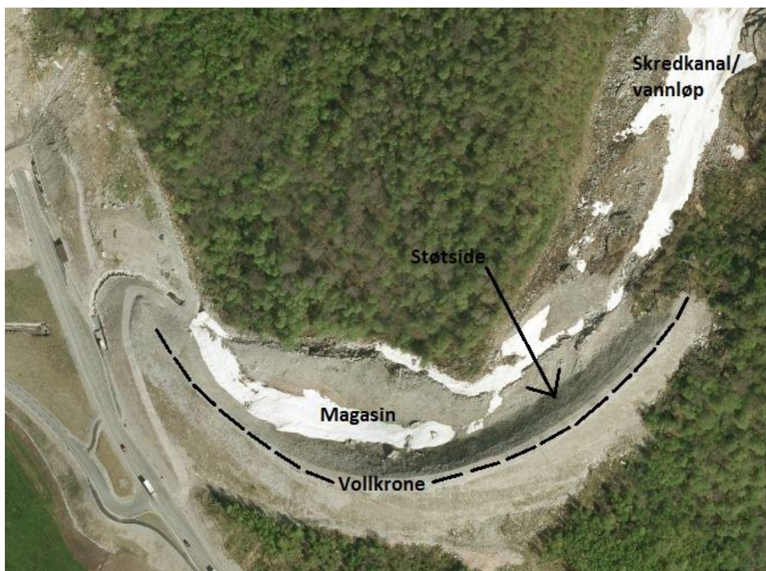
Figur 17: Viser de viktigste terminologiene til en skredvoll (kombivoll). Ortofoto av Lundevollen (Kartverket).
