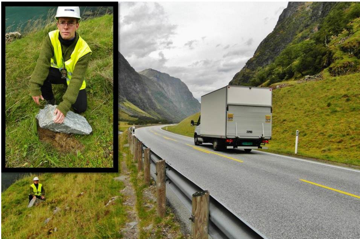
Figur 42: Stein som har beveget seg over både Våtedalsvollen 1 og E39 (foto: Feltarbeid 2013).
