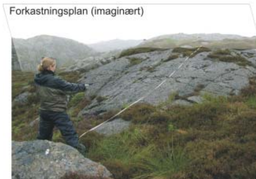
Figur 2.3. Prinsippet ved traversmetoden. Her er profilet lagt ved et lineament ved Sele, Bømlo. Bildet er tatt mot SV. Person som skala.
