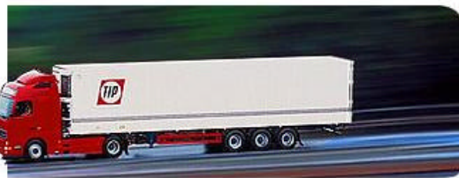
Bilde 1: Kontinentbil. 2-akslet trekkvogn påkoplet semitrailer med trippelboggi (Kilde: www.Volvo.no )
