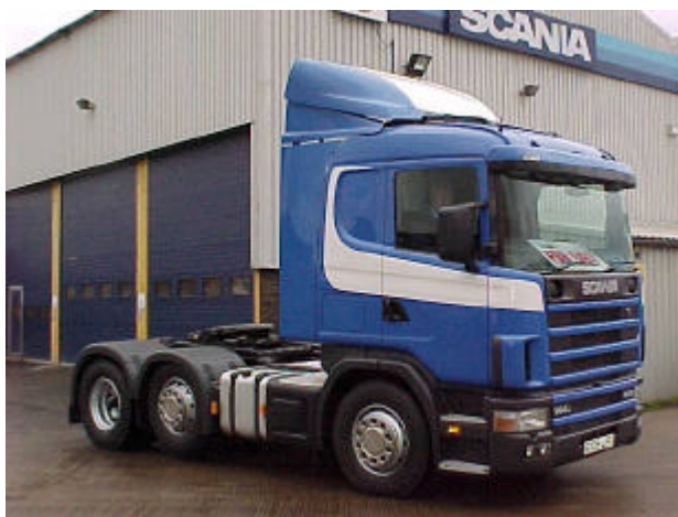
Bilde 2: 3-akslet trekkvogn med pusher-aksel (Kilde: www.Scania.se )
