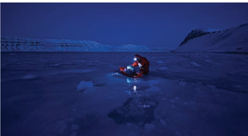
TEMPELFJORDEN/TEMPELFJORDEN Forsker Agneta Fransson fra Polarinstittuttet tar prøver av nydannet havsis og vann i Tempelfjorden på Svalbard. / Researcher Agneta Fransson from NPI takes samples of newly formed sea ice and water in Tempelfjorden in Svalbard. Foto/Photo: Jago Wallenschus, NP/NPI
