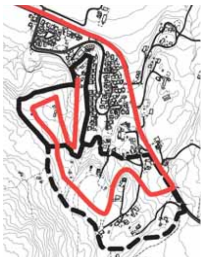
Fig. 3.01. Veifremføring gjennom Sæterbakken. Unngår vei med høye skjæringer gjennom LNFR-området. Går gjennom det båndlagte området som drenerer til drikkevannstunellen, forutsetter at sæterbakken er utbygd.
