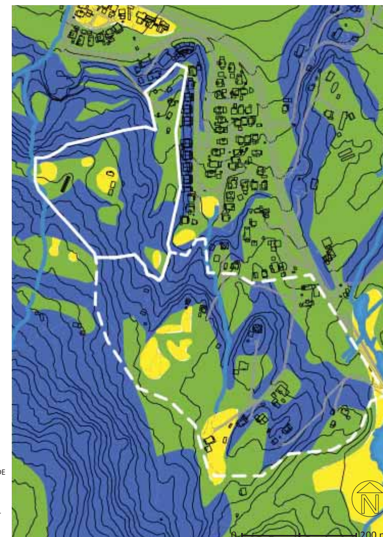
Fig.2.05. Egnethet for overvannshåndtering
