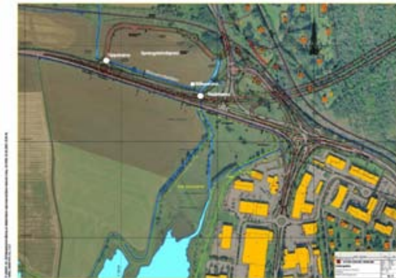
Figur 1. Målestasjoner i Homannsbekken. Stasjonene er plassert oppstrøms og nedstrøms mellomlager for tunnelmasse (sprengsteindeponi) samt i oppsamlingsbassenget for avrenning fra tunnelmassen.
