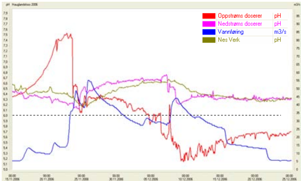
Figur 5. Elektrodebytte 25. november forhindret trolig uheldig forsureing i forbindelse med høy vannføring fra slutten av november til midten av desember 2006. Kalkvekta var ute av drift i hele denne perioden. pH-mål ved Nes Verk på denne tiden er vist med prikket linje.
