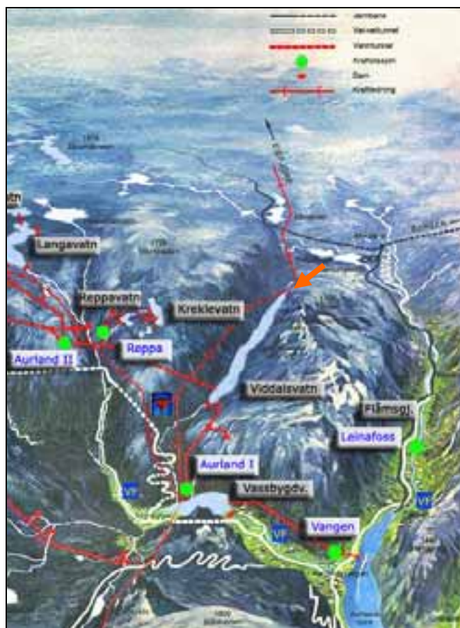
Figur 9: Oversiktskisse av Aurlandutbyggingen (E-CO vannkraft 2005). Mulig tilføring av vann til Viddalsvatn vist ved bred pil, gir større fleksibilitet i manøvrering av Aurland I og Vangen kraftstasjoner slik at vannføring og temperaturer i Vassbygdelva kan justeres til beste for laksen. Kilde: E-CO Vannkraft
