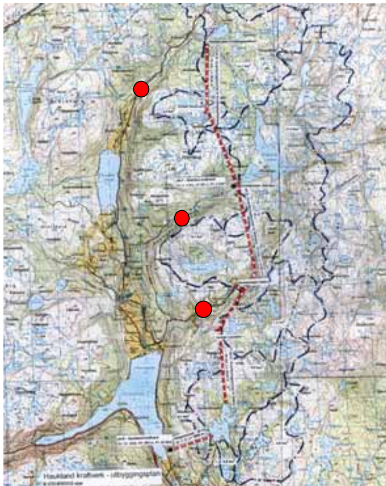
Figur 11: Oversiktskisse av prosjektene i Moisaeni, tre småkraftverk versus et stort. Røde punkter viser plassering av småkraftverk. Prosjektene, 3 små versus ett stort, er gjensidig utelukkende. Kilde: Dalane energi
