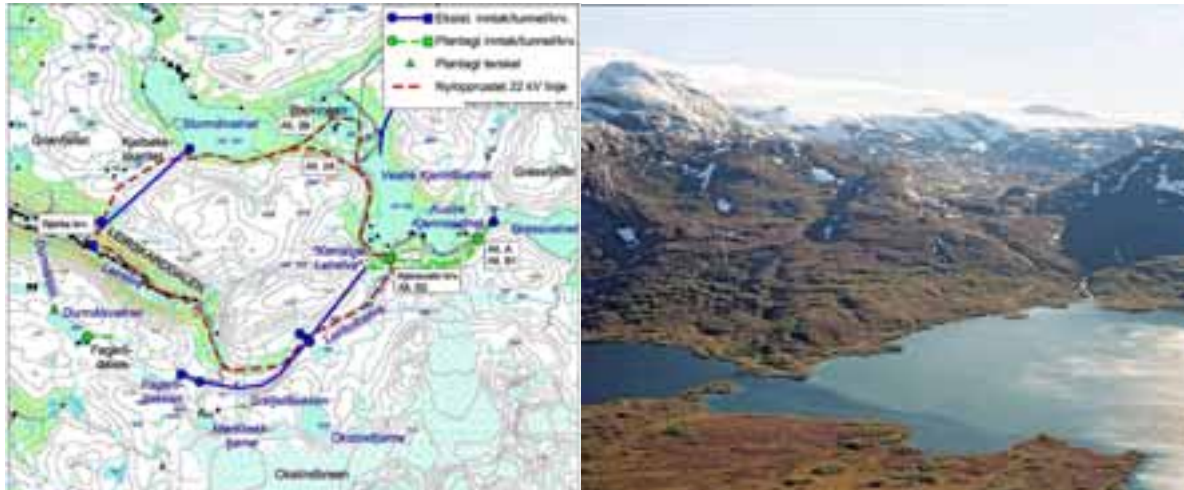
Figur 7: Kartskisse (og bilde) av prosjektet Kjennsvatn, Hemnes kommune Nordland (Statkraft, 2005). Tiltaket vil gi tidlig oppfylling av Gressvatn magasinet, mer stabil vannstand i gressvatn og Kjennsvatna, bedre isforhold, bevegelsesmuligheter for rein, mm.. Dette gir også bedret opplevelsverdi og tilgjengelighet for friluftslivsinteressene. NVE anbefaler konsesjon alternativ B2. (NVE des. 2005)
