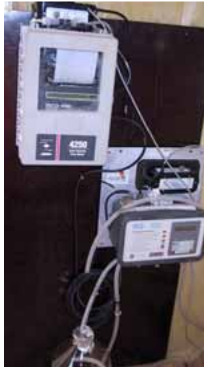
Figur 17. Måleinstrumenter i bu ved bassenget for kontinuerlig registrering av konduktivitet, turbiditet, temperatur og vannføring samt innhenting av vannføringsproporsjonale vannprøver.
