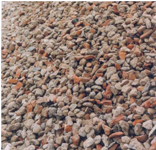
Figur 1: Resirkulert tilslag av Type 2 Blandet masse, 10-20 mm
