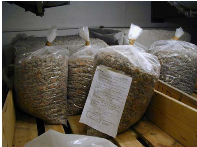
Figur 2: Resirkulert tilslag av Type 2 Blandet masse 10-20 mm levert i sekker på 40-50 kg fra BA Gjenvinning
