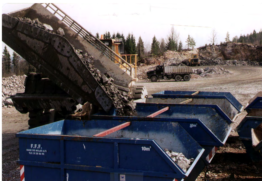
Figur 4. 1 1/2 skuffe tunnelmasse dumpes i hver testkontainer.
