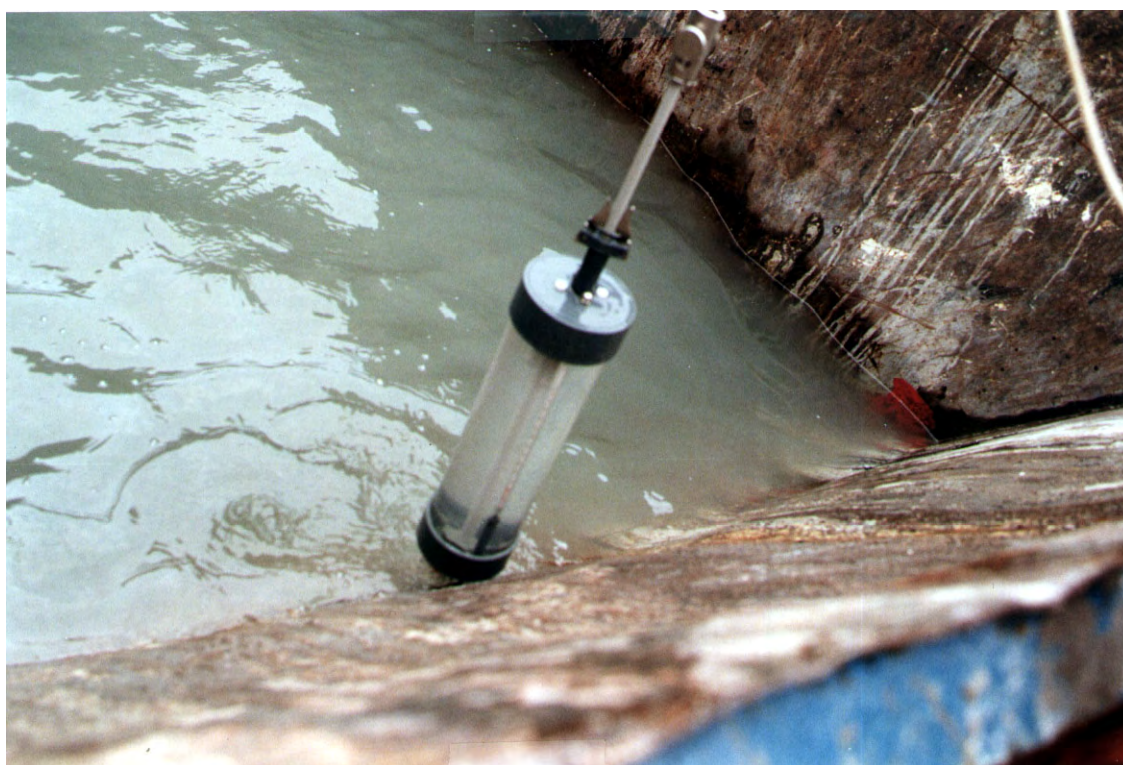
Figur 6. En vannprøve hentes opp med vannprøvetaker.
