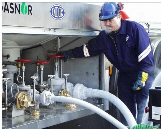
LNG-bunkring av skip. Legg merke til islaget på slangen som følge av den svært lave temperaturen i gassen. (Foto; Stavanger Aftenblad/Thomas Førde. Bildet er gjengitt med tillatelse fra rettighetshaver)
