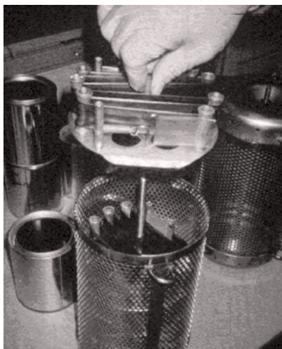
Figur 3. SPMD-er monteres beskyttet inn i et perforert stålbur som settes ut i miljøet.
