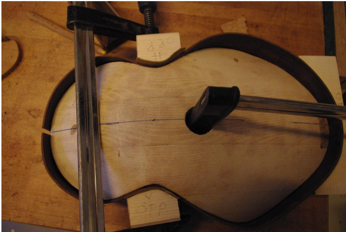
Figur 14: Sarger rundt den innvendige formen under liming av endekloss (taco). 88
