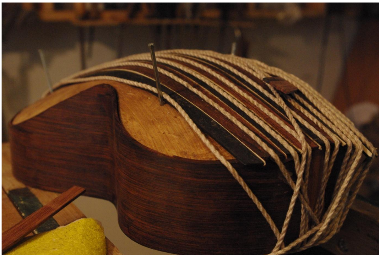
Figur 15: Bordene limes over den innvendige formen ved hjelp av hyssing og spiker 89
