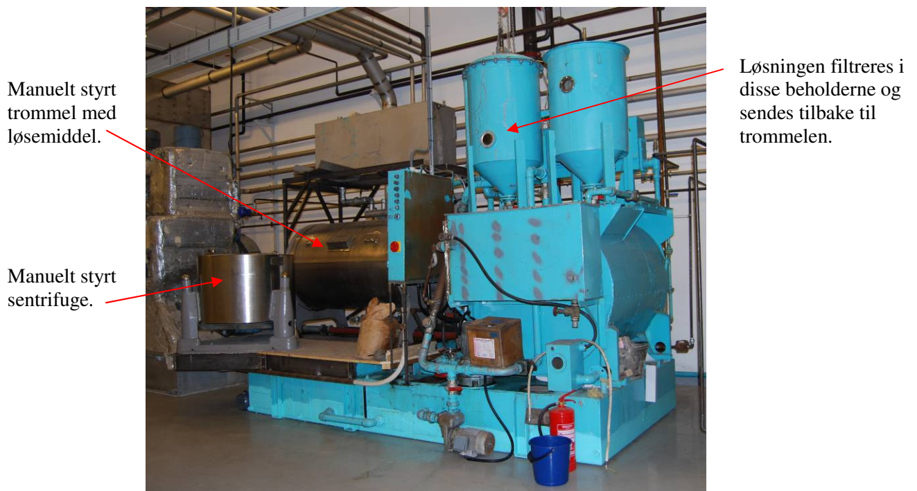
Figur a: Rensemaskin med manuelt styrt trommel, brukt til å rense tekstiler med metalltråder fra flere norske museer.
