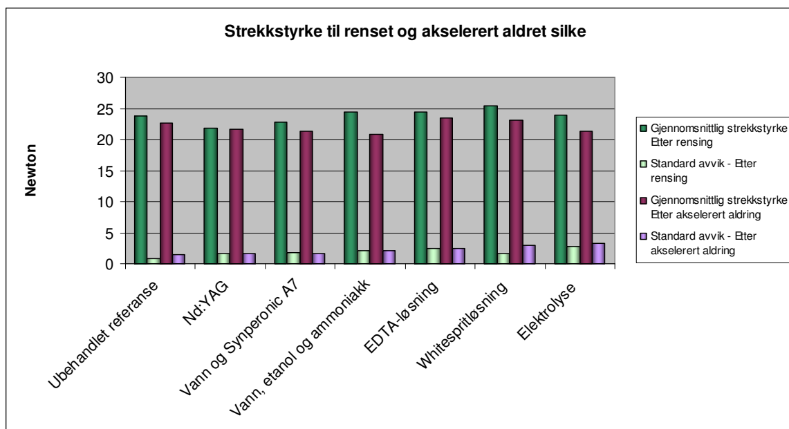
Figur 69: Diagrammet viser sammenlignende strekktester på ny silke renset med seks ulike metoder og akselerert aldret.
