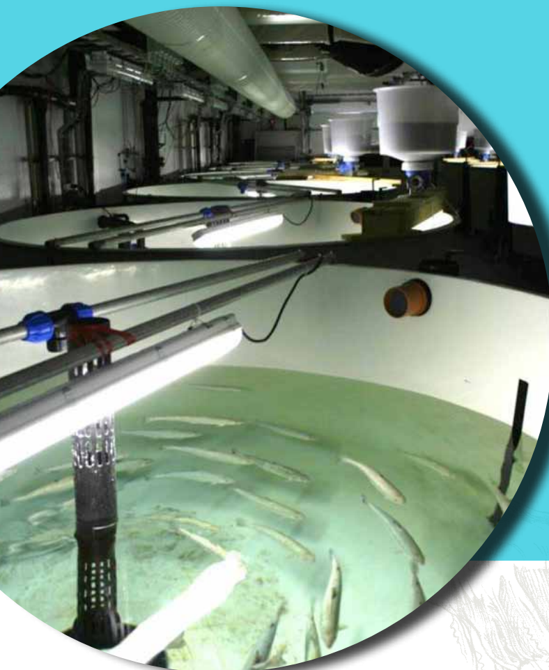
Figur 11: Miljøhallen ved Havforskningsinstituttets forskningsstasjon i Matre, der forsøk 2 ble gjennomført. Karene har automatisk styring av utføring, lys, vanngjennomstrømming og oksygentilførsel.
