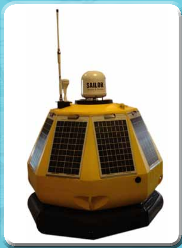
Figur 1: Bøye (APB 5, Saiv AS og Argus Remote Systems AS) for automatisk profilering av vannmiljø i laksemerd og fjord. Med jevne mellomrom sender bøyen en målesonde ned og opp i vannsøylen. Hver måleprofil vises automatisk på bøyens egen webside og kan i tillegg legges automatisk inn i en database på Norsk marint datasenter for sikker lagring. Mellom målingene er sensorene over vann for å hindre groe og for regelmessig kalibrering mot luft.
