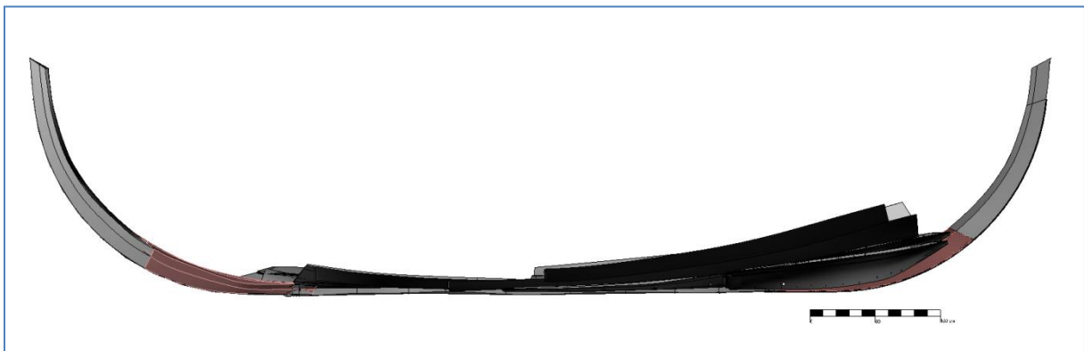
Figur 13. Illustrasjonen viser tolkning av utformingen av for- og akterstevn til Vaterland 1
