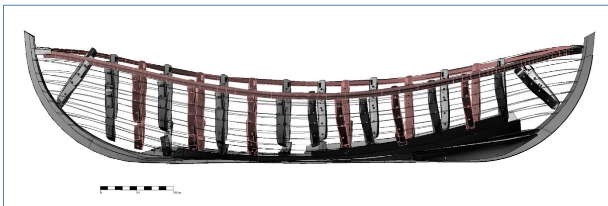
Figur 18. Rekonstruksjon med band, rong og stevnkær.
