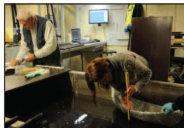
Fig 14. Vaterland 1 testes på vannet med vektlodd og målestokk.
