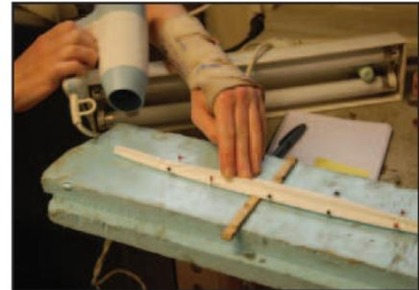
Fig 6. Oppvarming av kjølen i solidform før lagt i press.
