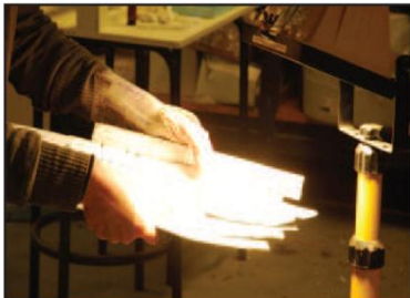
Fig7. Solidene i frontparti formes til med hjelp av varmelampe.
