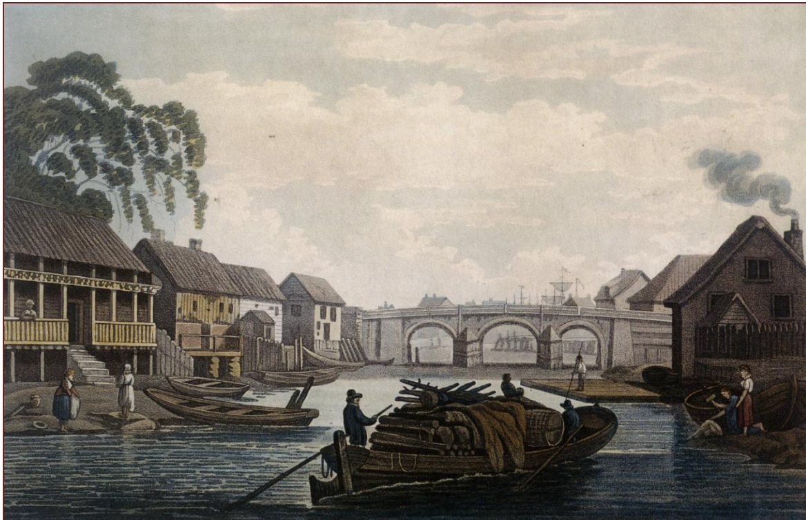
Figur 28. Vaterlands bro, et fargelitografi etter maleri fra omkring 1800 av kunstneren John W. Edy. Bildet kan gi en indikasjon på hvor mye lass en lignende type båt kan frakte per tur. Denne fraktebåten har akterspeil og er dermed trolig en annen variant. Båten viser bruk av tollepinner samt bruk av styreåre (Etter Ustvedt 1999:86).
