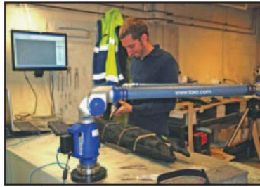
Fig.2. Dokumentering av båtdele til Vaterland 1 med bruk av FaroArm.
