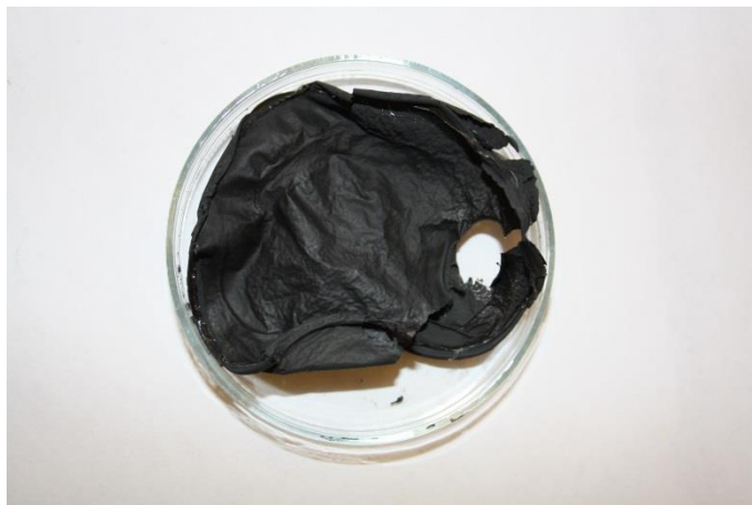
Figur 84: Katodetape syntetisert etter Metode 1. Tapen ligger i en glasskål.
