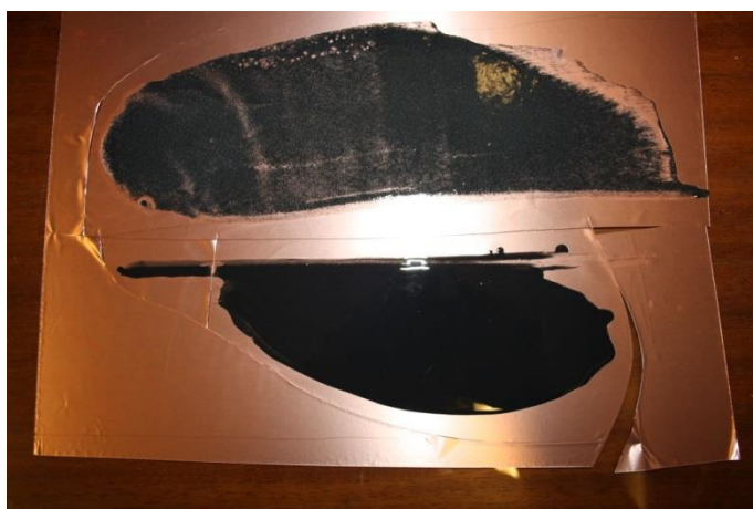
Figur 85: Bilde av katodetape hvor pulver ble mortret før turbo-røring (nede) og hvor pulver ikke ble mortret (oppe). Tapene ble doktorbladet til samme tykkelse.
