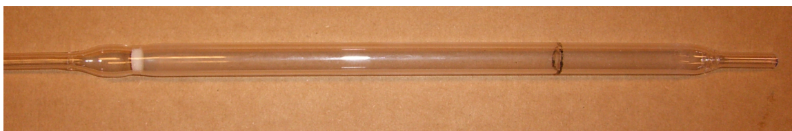
Figur 4-1 Bilde av en stasjonær-sjikt kvartsreaktor som ble brukt i forsøkene
