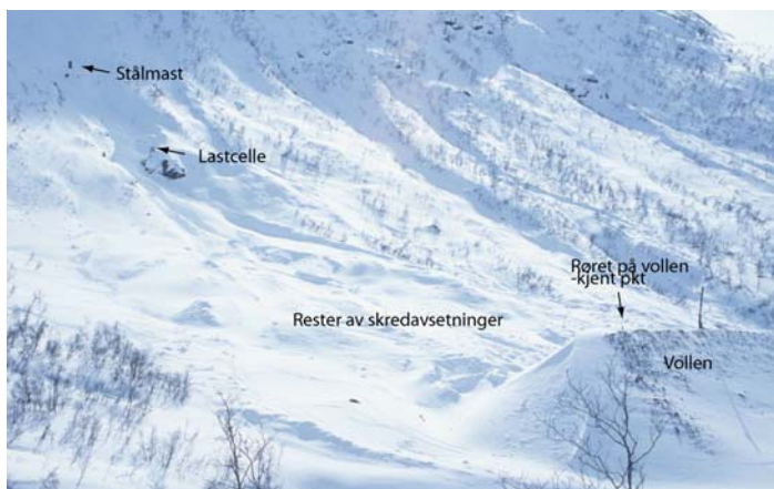
Figur 3.3 Utløpsområdet i Ryggfonn. Stålmasten og røret på vollen som brukes ifm oppmålingen av skredavsetningen er markert. Bildet er tatt ca en mnd etter at skredavsetningen ble målt opp. (Foto: W. Finsland)
