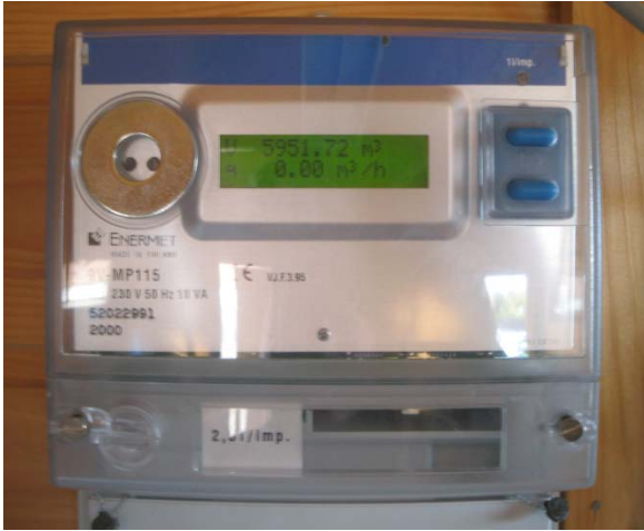
Figur 3. 14: Enermet MP115 volumstrømmåler som ble brukt for å måle hvor mye vann som sirkulerer i systemet.
