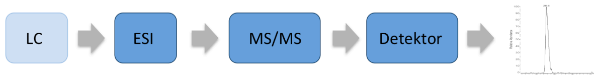
Figur 2.6 – Skjematisk oversikt over hvordan peptider detekteres ved hjelp av LC-MS/MS. Peptidene separeres ved væskekromatografi (LC), deretter ioniseres peptidene ved elektronspray (ESI) slik at de kan separeres basert på masse-ladningsforhold ( m/z -verdi) i masseanalysatoren (MS/MS) og detekteres.
