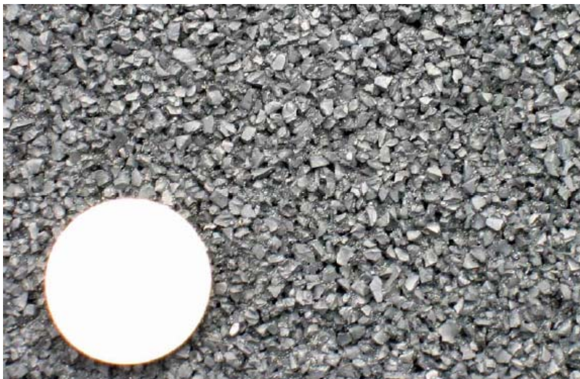
Figur 3: Poroelastisk dekke som ble lagt ut på PWRI sin teststrekning (Danish Road Institute 2005)
