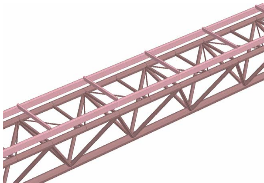
Figur 6.6 – Fagverket med langs- og tversgående RHS-profiler. Klossene som RHS-profilene ligger opp på er ikke tegnet inn.
