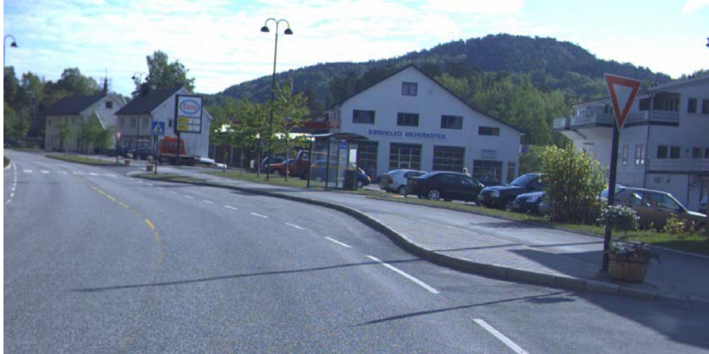
Avlastet tidligere E18, nå rv 418 gjennom Søndeled sentrum, med fortau, GS-veg, rabatter, gangfelt, busslommer med venteskur.
