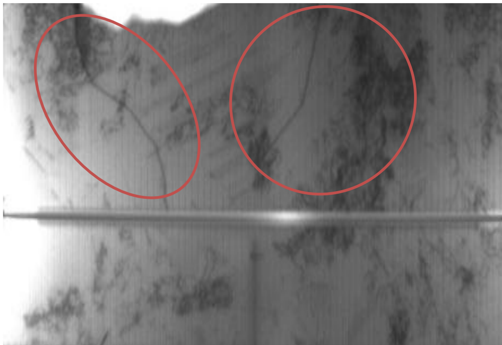
Figur 4. 16: Elektroluminescens bilder av solcelle, første bilde viser solcelle før test og bilde under viser området indikert med rødt der solcellen etter brudd-test er sprukket og har dislokasjoner på solcelle.
