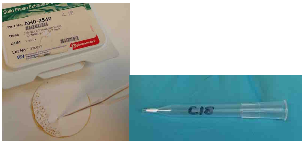
Figur 5.6.1 – Venstre: viser produksjon av C18 SPE kolonnen. Høyre: viser en ferdig produsert C18 SPE kolonne.
