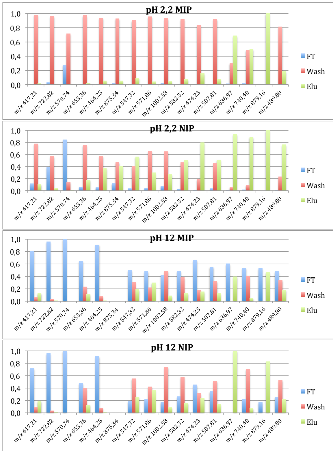
Figur 6.6.9 - Viser flow through, vask og eluering for peptidene ved forskjellig pH for MIP og NIP. Bakgrunnen for kolonnene vises i tabellene 7.3 og 7.6 i appendiks 7.
