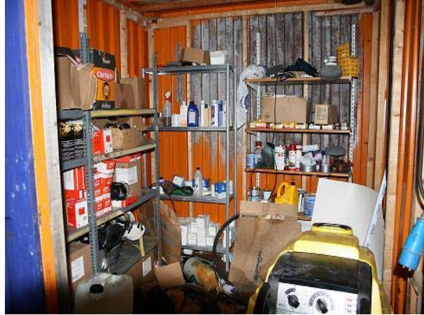
Bilde 9 og 10: Eksempel på dårlig brannhygiene i båthotell 3. Bildet til høyre er en brannkåpe plassert inne i lageret. Den stod åpen ved ankomst.
