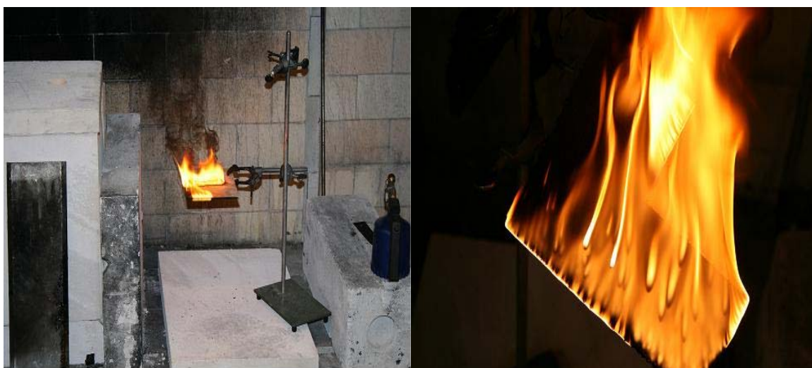
Bilde 5 og 6: Bilder fra forsøket med å brenne GUP i brannlaboratoriet ved HSH.
