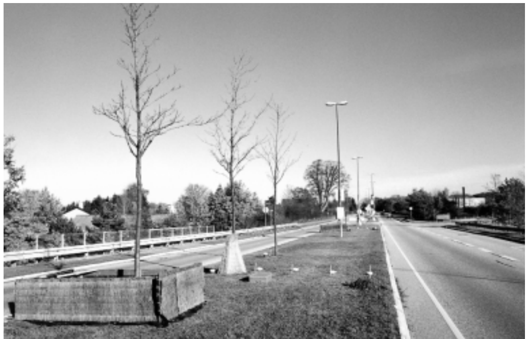
Forsøgsstrækning i Frederiksborg amt. Saltkoncentrationen måles ved hhv. træer uden beskyttelse, ved halmkegler og ved halmmåtter placeret ud til vejkannten. Derudover måles koncentrationen af saltsprøjt fra vejkannten. Vinteren 1997/1998.
