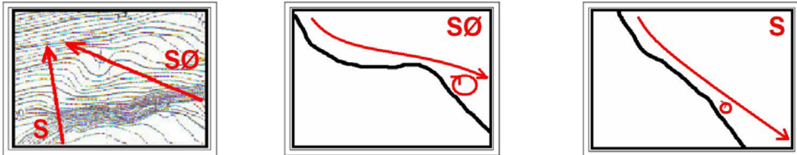
Figur 3.4.18,19 og 20: Viser forskjellen vind fra sørøst får i høydeforandring i forhold til vind fra sør, og innvirkningen dette får for resirkulasjonssoner. Hvis man ser nærmere på høydekurvene på figuren t.v. ser man hvorfor det blir slik.
