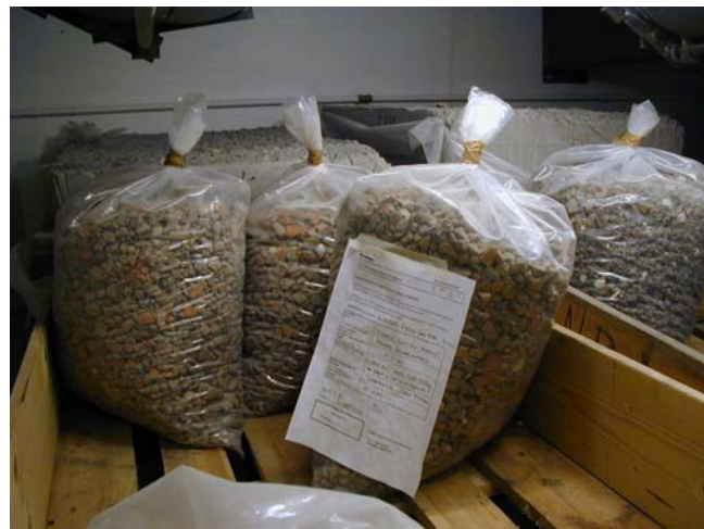
Figur 2: Resirkulert tilslag, Type 2 10-20 mm levert i sekker på 40-50 kg fra BA Gjenvinning
