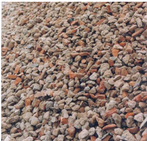
Figur 1: Resirkulert tilslag, Type 2 10-20 mm
