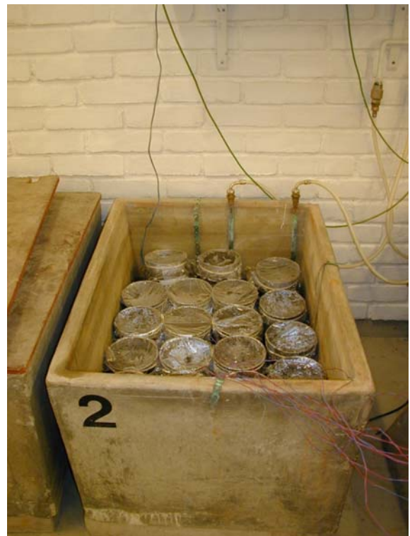
Figur 5: Tining av prøver i vannbad
