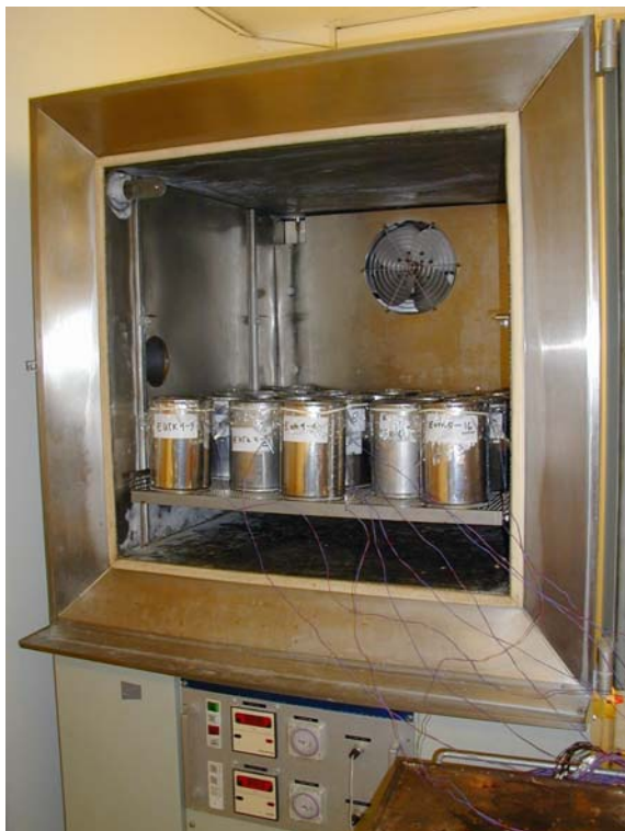
Figur 4: Frysing av prøver i klimaskap
