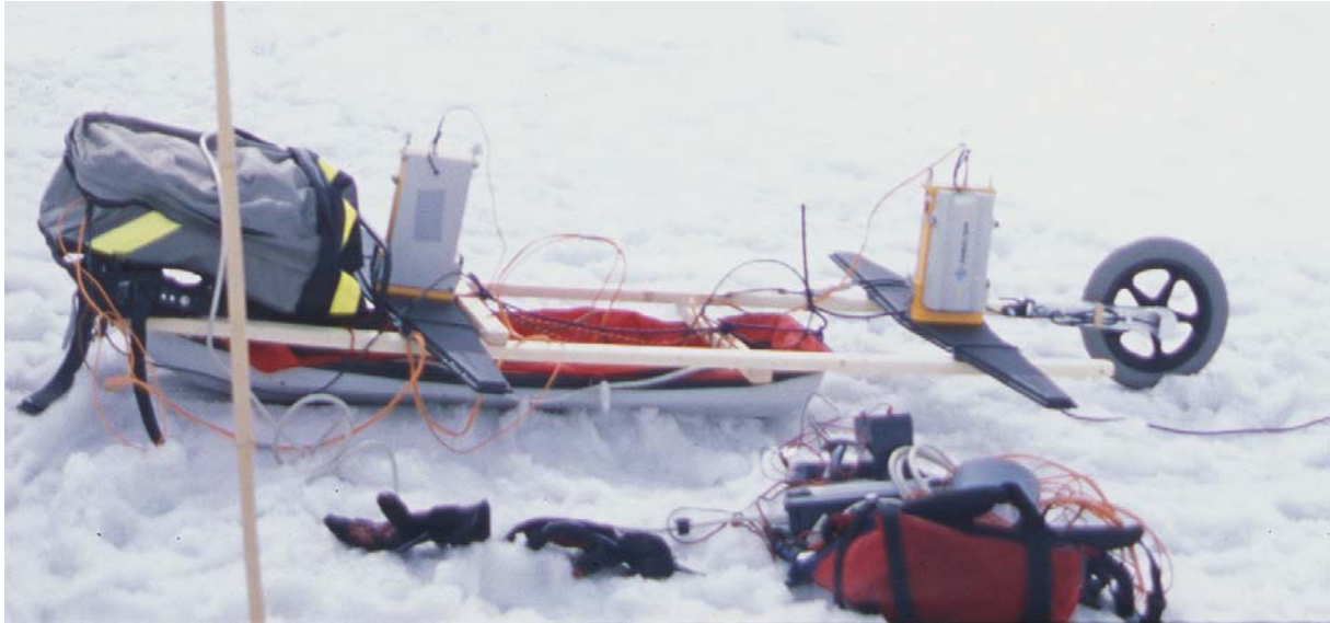
Bilder 4.6 Oppsett av GPR med antenner og kontrollenhet (i sekken).
