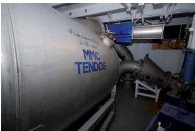
Figur 9. Vakuum-tank samt forkammer for pumping av levende fisk.
