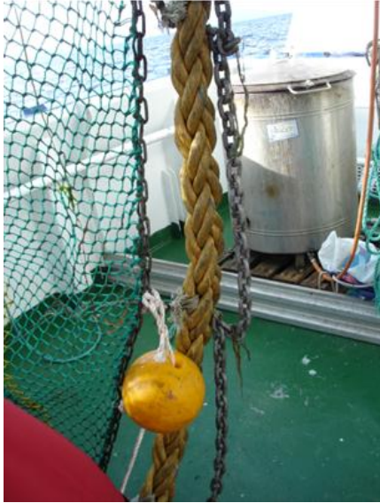
Figur 2. Sabb som montert på reke trålen under forsøkene.
