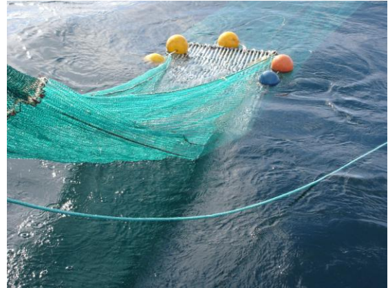
Figur 3. Sorteringsrist av glassfiber spiler montert i en seksjon av kvadratiske masker.
