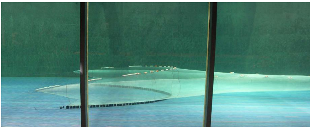
Figur 1. Modell i 1:5 skala fra prøvetanken i Hirtshals av samme trålkonstruksjonen som ble anvendt i forsøkene med MS "Fangst" (se Appendix 1).
