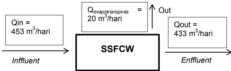
Gambar 5. 2 Skema evapotranspirasi di unit SSFCW
