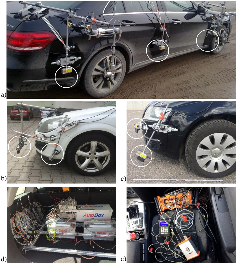
3.2 pav. Tyrimų metu naudota įranga: a) automobilis „Mercedes-Benz E350“; b) automobilis „Opel Astra“; c) automobilis „Audi A6“ su pažymėtais lazeriniais jutikliais Corrsys-Datron HF-500C ; d) realiu laiku atliekamų skaičiavimų įrenginys AutoBox dSpace ; e) duomenų surinkimo įrenginys Corrsys-Datron DAS-3 Fig. 3.2. Measuring equipment during experimental tests: a) a car Mercedes-Benz E350; b) a car Opel Astra; c) a car Audi A6 with marked laser height sensors Corrsys-Datron HF-500C ; d) real time target device AutoBox dSpace ; e) data collection device Corrsys-Datron DAS-3 ;
