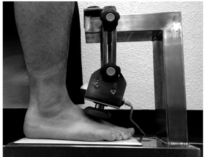
図2 測定デバイスを用いた足関節背屈筋力の計測
