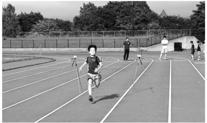
図8 光電管での50m走タイム測定
