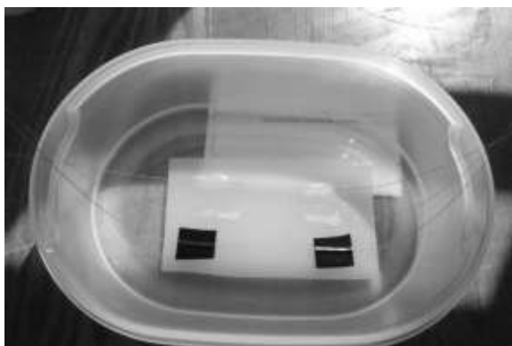
Рис. 2. Процесс травления волокна с записанной ВБР
