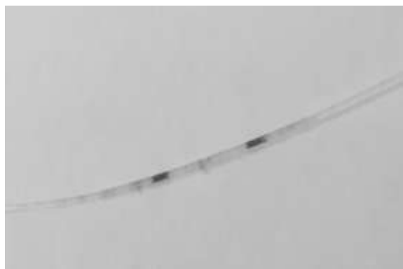
Рис. 4. Участок волокна с восстановленным полиимидным покрытием – датчик деформации
