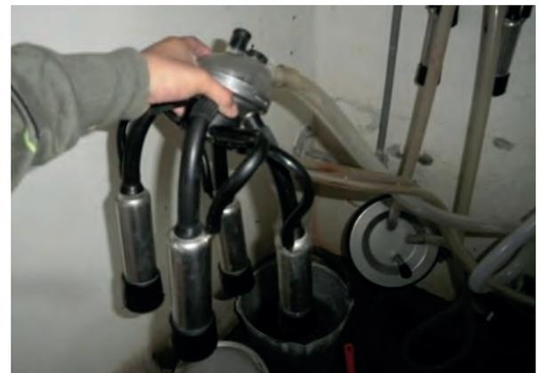
Componentes de la ordeñadora mecánica, las cuales en IVITA utilizan solo el pulsador conectado del aire al colector, priorizando el pulsador evitan utilizar los demás elementos justificando que no es necesario y que estos demás elementos no son necesarios
