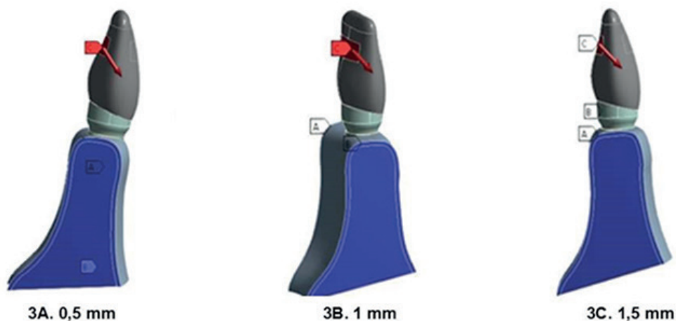
Figura 3. Dirección de fuerzas en cada espesor: 3A. 0,5 mm, 3B. 1 mm, 3C. 1,5 mm
