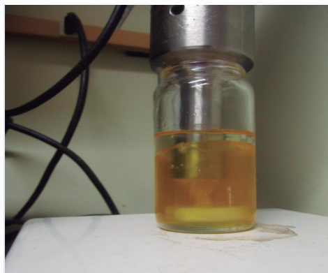
Figura N° 4. Muestra siendo tratada con el método de ultrasonidos.
