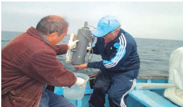
**Figura N° 3.** Toma de muestra con botella Niskin.
