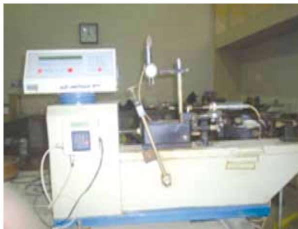
Figura N.º 7. Equipo de pruebas de corte en suelos (Lab. Mec. de suelos Fac. de Ing. Civil UNI).
