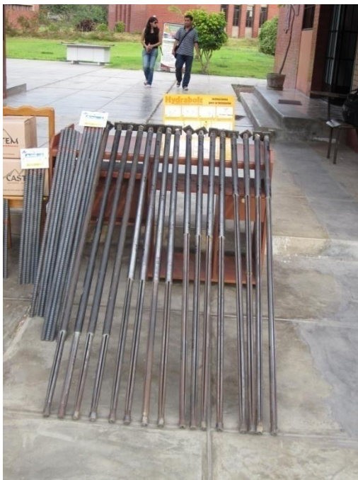
Foto N° 4-1: Pernos Hydrabolt entubados
